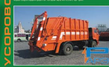
ТРАДИЦИОННЫЙ МУСОРОВОЗ С ЗАДНЕЙ ЗАГРУЗКОЙ + ДЛЯ ПЛАСТИКОВЫХ КОНТЕЙНЕРОВ 0,12 – 1,1М3, СТАНДАРТНЫХ 0,8М3, ОЦИНКОВАННЫХ 0,77 – 1,1М3 И БУНКЕРОВ 7,5М3
