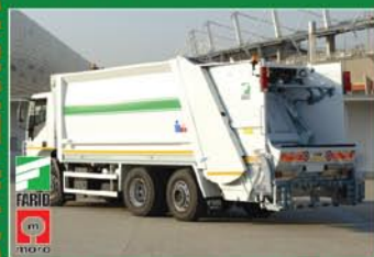
БОЛЬШЕГРУЗНЫЕ И ТРАНСПОРТНЫЕ МУСОРОВОЗЫ: T1 И SUPER. Емкость кузова от 12 до 45 куб.м. + коэффициент уплотнения 6:1
